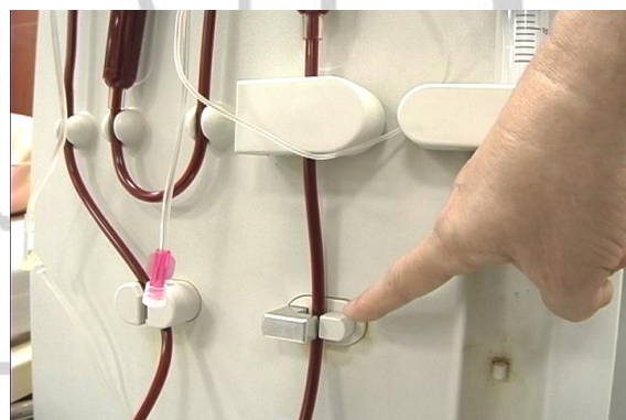
(圖十四)確認氣泡偵測器已啟動
